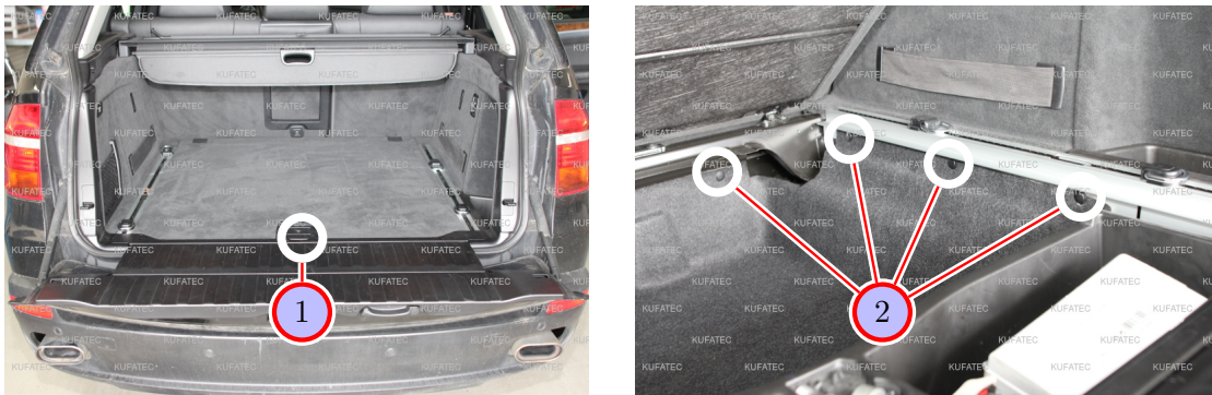
Abbildung 7: Demontage Verkleidung Kofferraum
