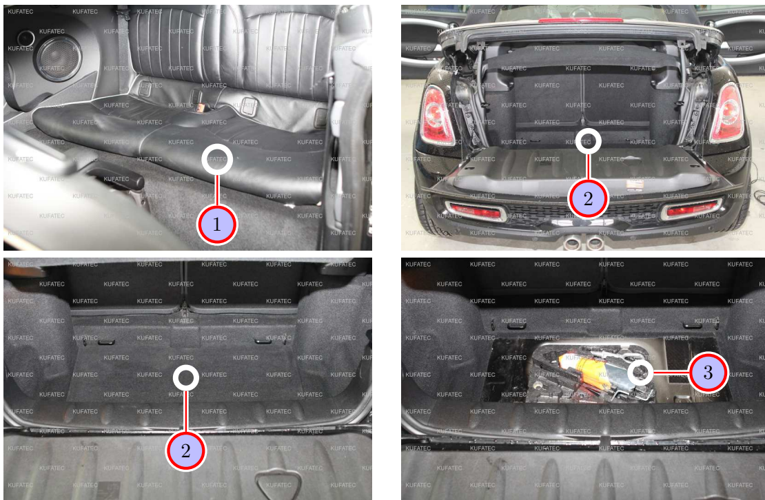
Abbildung 6: Demontage Rücksitzbank / Verkleidung Kofferraum
